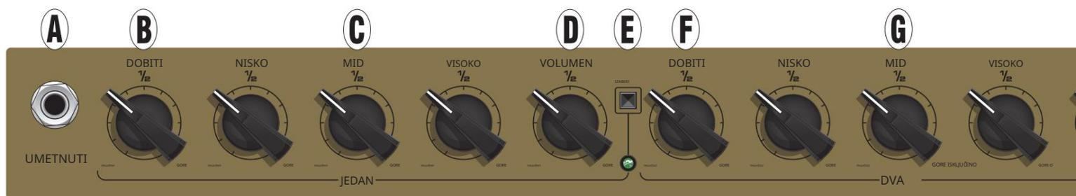
A. ULAZ: Ovdje uključite svoju gitaru. Koristite samo visokokvalitetni oklopljeni kabel instrumenta.
